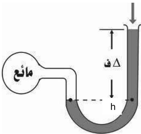
يستخدم المانومتر في قياس ضغط بعض الموائع ( غاز أو سائل )
